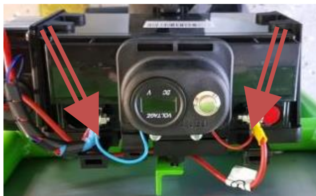
obr. č. 8. - označení místa, kde se odšroubuje akumulátor od vodičů
