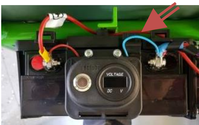
obr. 7. - odpojení akumulátoru z držáku
